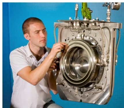
図1：(左) 加速器と標的が設置された標的ステーションの間を仕切る薄い壁が「ビーム窓」です。ビーム窓には加速器で標的に向け加速された大強度陽子ビームが繰り返し入射します。(右) J-PARC ニュートリノ実験施設のビーム窓。高強度な 64 チタン合金でできています (提供 : STFC RAL)。
