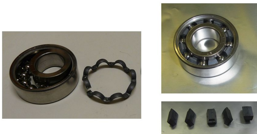
図2：従来の固体潤滑剤を利用した軸受では、ボール、外輪、内輪、ボールの保持器に二硫化モリブデンや銀をコーティングしていた（左）。J-PARCでは二硫化タングステンの塊（右下）をボール間に挿入した軸受（右上）を採用した。
