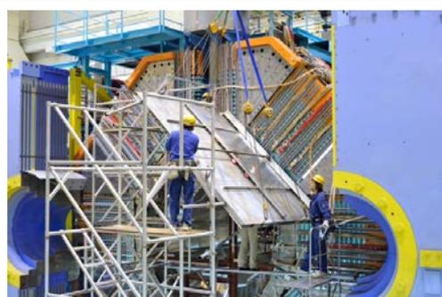
図 5: バレル部の組み込みの様子
