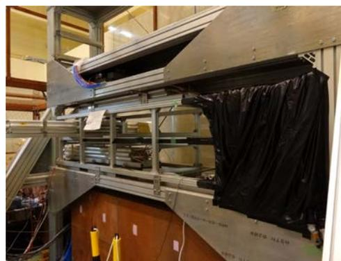
図5: プロトタイプの宇宙線テスト風景
