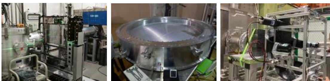
図2 Phase- \alpha で使用する検出器。(左)中国CSNSで試験中のファイバートラッカー。(中央)ストローチューブ飛跡検出器。(右)MLFで試験中のレンジカウンター。
