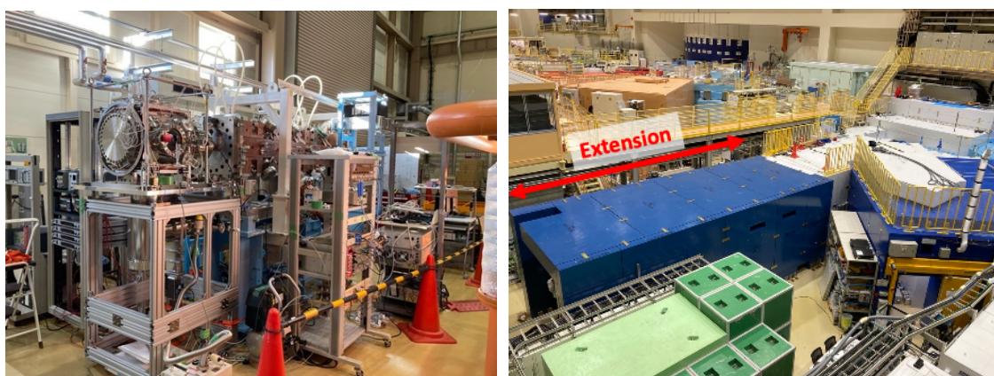
図 2 ミューオンの冷却・加速実証実験の装置アSEMBリ試験（左） MLF H ライン延伸のために製作・設置された遮蔽体（右）
