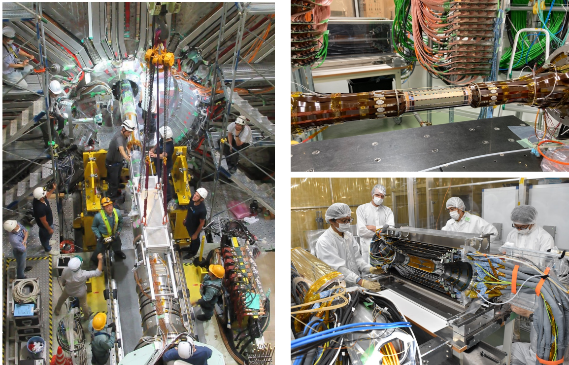
図 1: (左) VXD の取り出し作業の様子、(右上) 新型衝突点ビームパイプへの取り付けが完了した PXD、(右下) 取り出した VXD を半分に分割して分離した SVD の片側。
