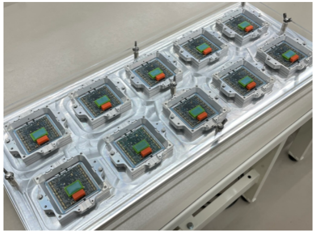
図6：量産試作で製造した ITk ピクセルモジュールの一例。
