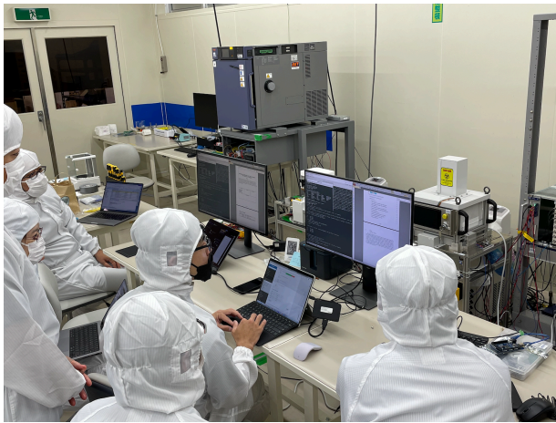
図5：ITk ピクセルモジュールのアセンブリと続く品質検査を行うクリーンルームにおいて量産試作システムを用いた検査を実施する様子。
