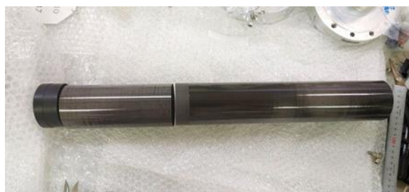
K1.8BR 実験エリアでのセットアップ作業中の E73 実験標的 E90 実験用 H 2 標的 CFRP 製の散乱真空筒の薄肉化をめざす
