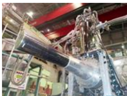
K1.8BR 実験エリアでのセットアップ作業中の E73 実験標的 E90 実験用 H 2 標的 CFRP 製の散乱真空筒の薄肉化をめざす
