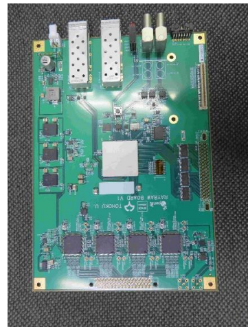
図 3. Drift chamber の新しい読み出しエレキ。
