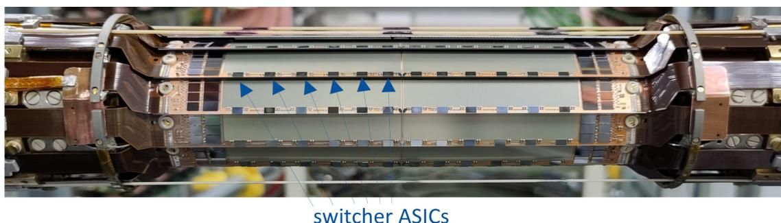
図 2: PXD のラダー上に配置されたスイッチャーの ASIC。この一部が SBL による損傷を受けた。
