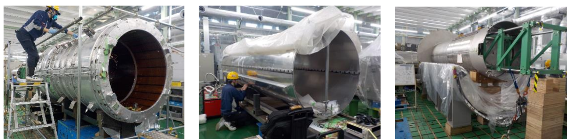
組立中のコールドマス
