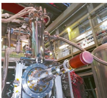
E73 実験用 H 2 , 3He, 4He 各標的液化試験@ハドロン K1.8BR
