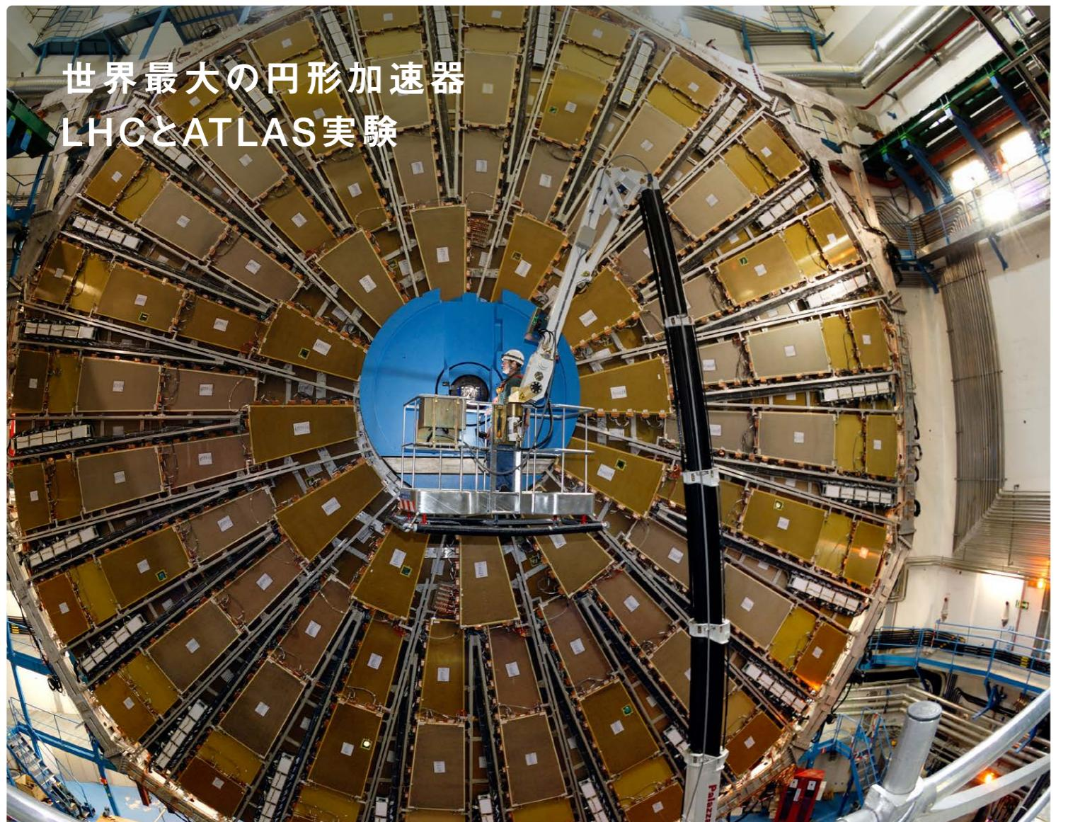
LHC(大型ハドロン衝突型加速器)は、世界最高の衝突エネルギーを誇る円形加速器です。そのひとつの衝突点で起こる反応を直径22メートル、長さ43メートル、総重量7,000トンという巨大なATLAS検出器で観測します。ATLAS実験は、約3,000人(修士課程の学生やエンジニアなどをふくめると6,000人に近い)からなる国際共同実験で、エネルギー・フロンティアグループは、検出器の建設から物理解析に至るまで、ATLAS実験の中で中核的な役割を担っています。
