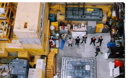
超冷中性子という非常にエネルギーの低い中性子を物質容器に閉じ込め、電磁場中でのスピン歳差運動を超精密に観測することによって中性子EDMを探索しています。カナダTRIUMF研究所に世界最大強度の超冷中性子源を建設し、先行実験と比べて10倍の測定感度で中性子EDMの発見を目指しています。
