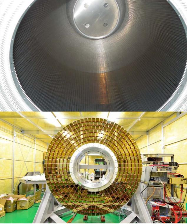
(写真上)中央飛跡検出器：チェンバー内に約5万7千本のワイヤーが張られています。
