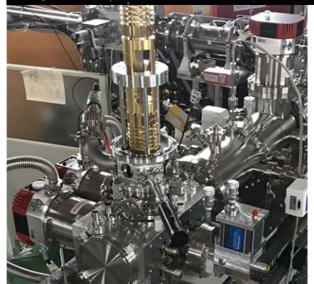
KISSは、とりわけ金・白金やウランの起源となる短寿命の原子核の生成に適した装置です。新たに開発された多重反射型飛行時間測定式質量分光器（MRTOF）を使って、元素の起源の解明を目指しています。MRTOFは超重元素で
