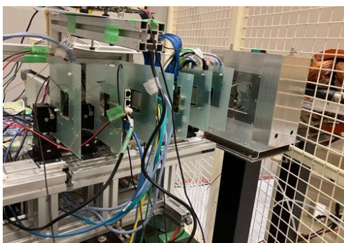
図 2. 測定器開発テストビームラインで用いたテレスコープ
