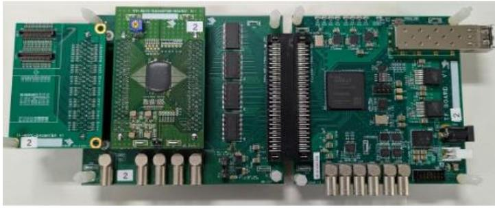
図5 Belle II 実験用の MPPC 読み出し ASIC 回路基板
