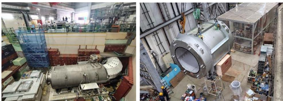
図1 超伝導磁石システムの建設状況。左：ハドロン南実験棟に設置されたパイオン捕獲ソレノイドとミュオン輸送ソレノイド、右：つくばキャンパスに納品された検出器ソレノイド。
