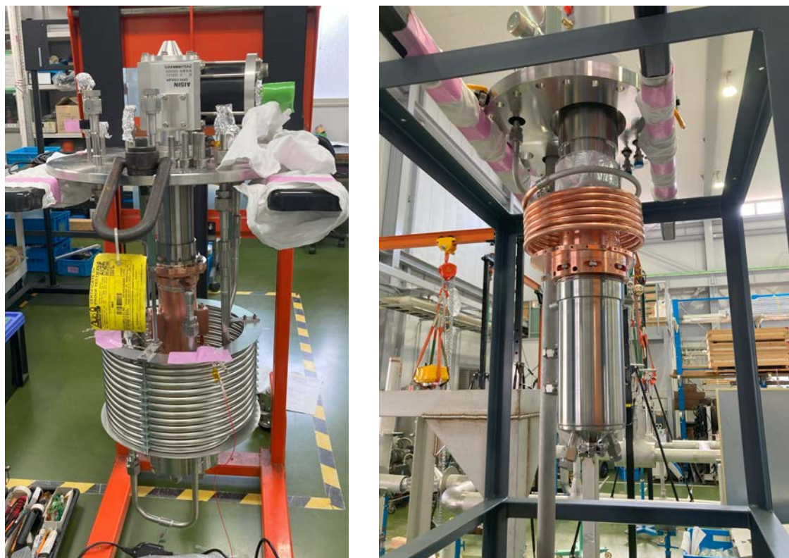
図 3 (左)重水素精製機: 冷却された活性炭トラップにより不純物を除去する (右)重水素冷凍機: パルスチューブ冷凍機により重水素を液化・冷却する
