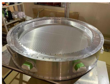
図5 飛跡測定用ストローチェンバー 1セット。
