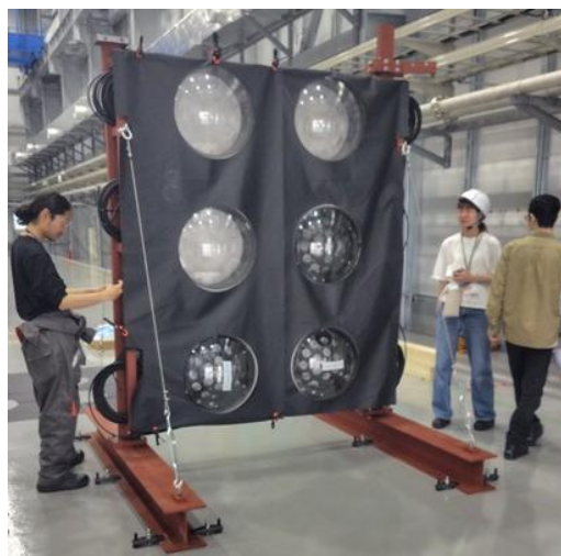
図4 J-PARC 実験機器開発棟に搬入された IWCD 検出器装荷検討用モックアップ。
