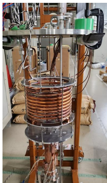
図6 自作した低温精製器（活性炭フィルター）のインサート。
