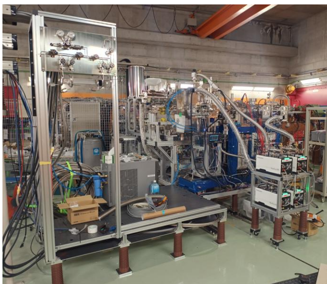
図 10：実験室に設置した KISS-1.5 用のハウジングチェンバーおよび MRTOF 質量分光器。オフライン試験に向けて、真空排気系、ガス供給系、冷却系などの整備を進めている。
