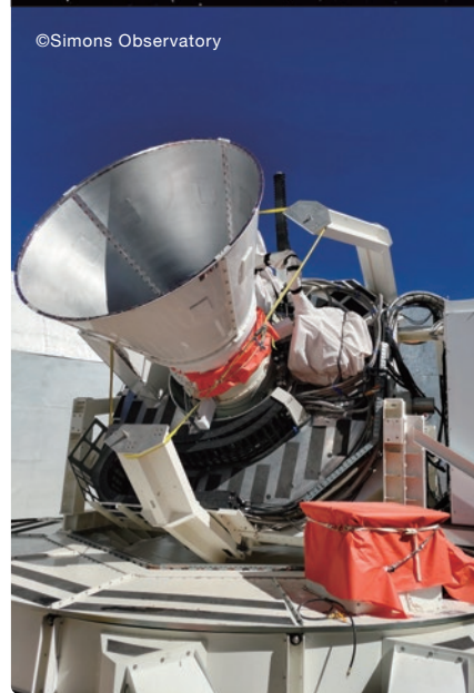
(左)Simons Observatory 小口径望遠鏡 (右)Simons Array TESセンサーアレイ
