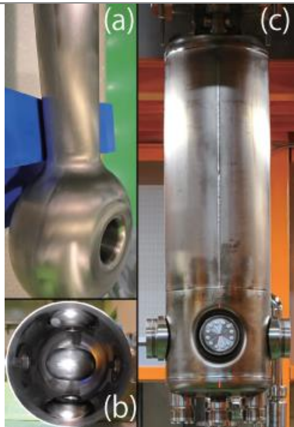
図3 製作した超伝導加速空洞の写真
