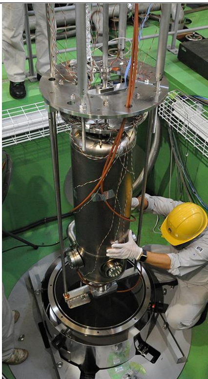
図4 高エネルギー加速器研究機構内で行った超伝導加速空洞の試験 空洞がクライオスタットに組み込まれようとしている。
