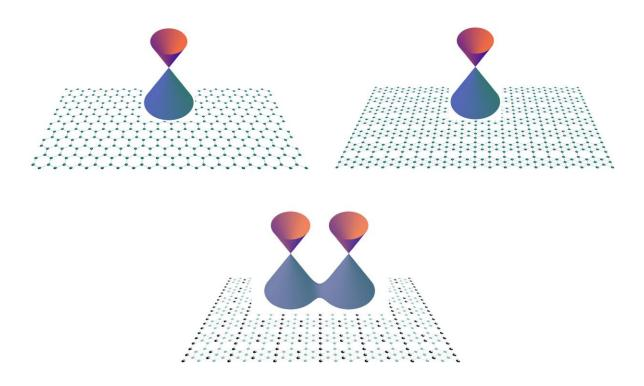
(図2)「質量ゼロ」粒子を表す運動量とエネルギーの比例関係(ディラック・コーン)および各原子構造。丸は原子を表し、特に基板との相互作用で影響を受けた原子は大きめの黒丸で示してあります。蜂の巣構造以外でも質量ゼロ粒子が原子シート内に形成され、基板との相互作用でさらにそのペアを形成することができます。
