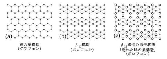
(図1)各原子構造。 $\oplus$ は原子を表し、白丸は電子が集中した原子に対応。(a)グラフェン、(b) ボロフェン、(c)ボロフェン $\beta$  12構造の電子状態。
