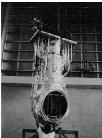
第7図 電子対発生検出用 Ta板をセットした 1m 水素泡箱本体
