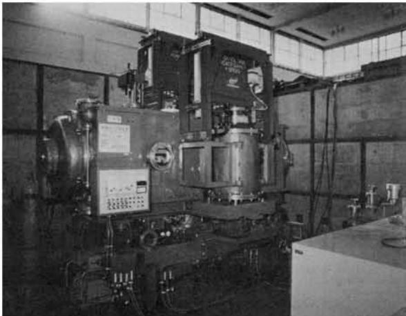
第2図 電源組込型静電粒子分離装置
