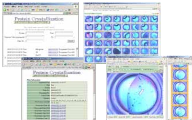
閲覧者は、ユーザ名、タンパク質名、分注の年月日等で目的のプレートの検索を行うことができる。プレート番号をクリックすることで、プレートの情報、取得画像のサムネイル表示ができ、ウェルの画像表示画面では、成長の様子を時系列で見ることができるようになっている。さらに、倍率、明るさ、偏光フィルタの角度を変えた画像を取得するための特別観察の設定を行うこともできる。
