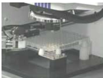
結晶化プレート内のドロップの様子をあらかじめ決められたスケジュールに従ってCCDカメラを用いて撮影し、画像ファイルとして画像サーバーに保存する。研究者はウェブブラウザを用いて画像の閲覧を行う。
