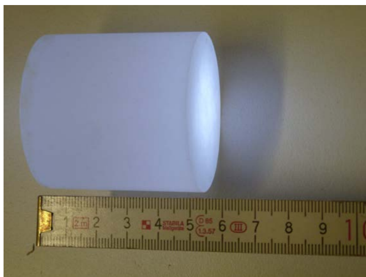
図 2.3 シンチレータの一種である CsI (Tl) 結晶が発光する様子（出典：Photo by My-Name(A1000), CC BY-SA 3.0, https://commons.wikimedia.org/wiki/File:Kristall-CsI(Tl)_mit_Skala.jpg ）
