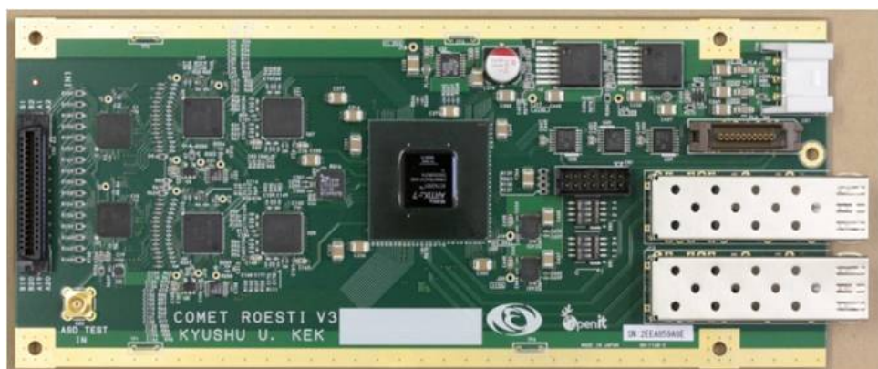
図 2.7 最先端の素粒子実験で使用するための電子回路の例。COMET 実験という J-PARC で行われる実験のために開発が進められています。
