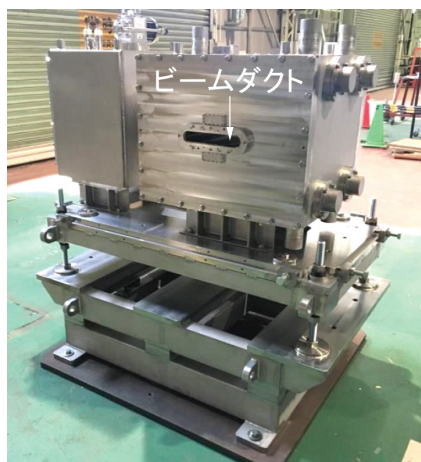
図1 高温超伝導電磁石の外観
