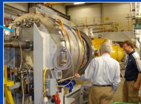
•9連空洞 x 9: 加速器ユニットとしては、30 MV/mのレベル、
