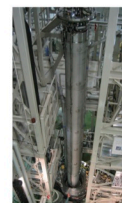
縦型クライオスタットに挿入中の7m実機マグネット
