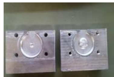
図 5 : CAM で製作した加速空洞
