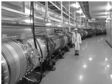
加速器用超伝導磁石の例。J-PARC T2K ニュートリノビームライン超伝導磁石システムは、30GeV 陽子ビームをニュートリノ生成ターゲットへ導く。
