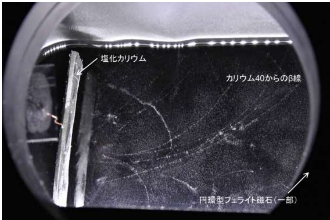
写真 小型霧箱でみた磁場中 (~300 ガウス) を飛行するカリウム 40 からの \beta 線。磁石の円環部内径 12cm。霧箱の底部にもフェライト磁石複数が設置してある。
