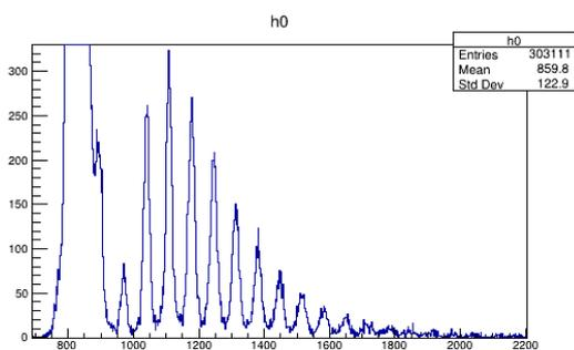
光の発生には、LED を用います。光検出器には、MPPC（上図）と呼ばれる、光子の数を数えることの可能な検出器を用いてみましょう。左図は得られた信号のイメージで、横軸が検出器の信号の高さ、縦軸が観測事象数です。各事象のエネルギーが離散的に見えていることがわかります。
