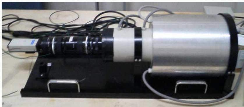
図3.1 IIT(C4963)+CCDの写真
