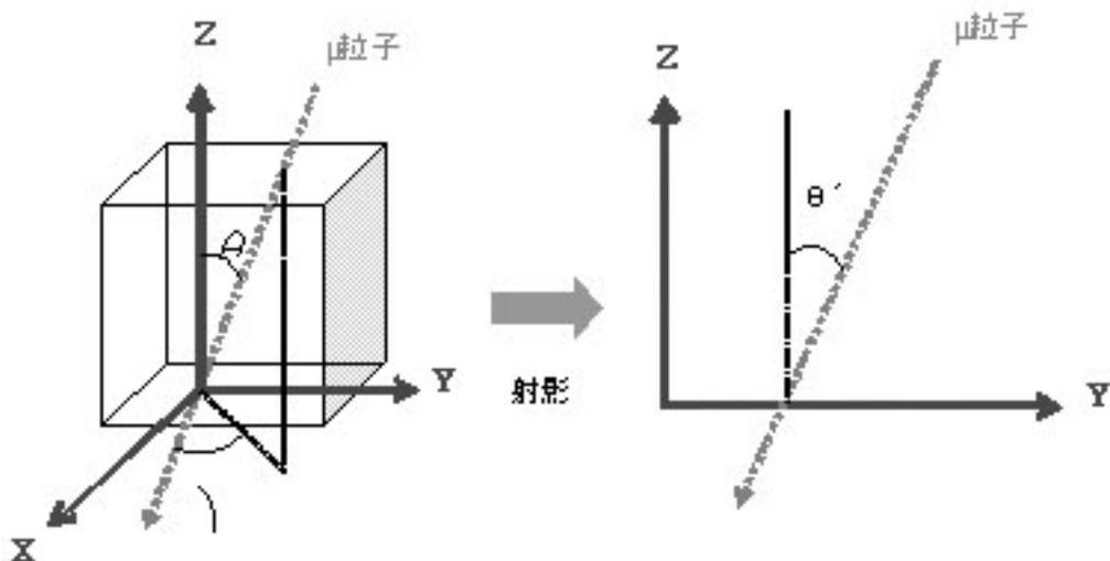
図 13 天頂角  $\theta$  の射影  $\theta'$  が実験で観測される
