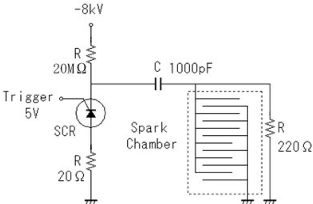
図7：高電圧印加回路
