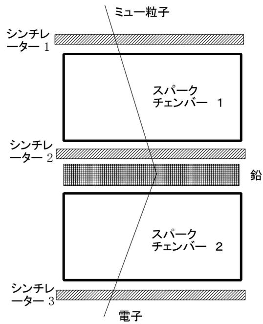
図 16 ミュー粒子崩壊観測装置の概念図
