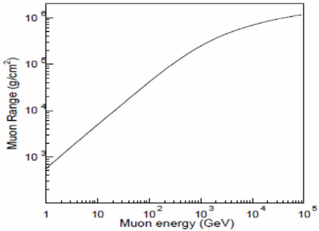
図 11 ミュー粒子のエネルギーと飛程の関係
