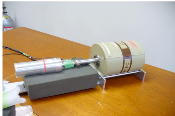
最後はいよいよ角度相関の測定です。真ん中に線源 ( $^{60}\text{Co}$ ,  $^{22}\text{Na}$ ,  $^{207}\text{Bi}$  など) を置き、そこから 15cm くらい離して2台（以上）の検出器を置きます。1台目の検出器は固定しておいて2台目の検出器を動かし、1台目の検出器-線源-2台目の検出器がなす角度を次々変えながら測定を繰り返して、角度によって  $\gamma$  線を同時計測する計数率がどれくらい変わるかを測定します。ここで、検出器と線源の間の距離が変わってしまうと、角度相関が無かったとしても計数率が変わってしまうので注意が必要です。こういった誤差（系統誤差）をどうやって減らすかや、どれくらいの系統誤差があるのかを見積もるのも測定の大切な一部です。単純なやり方しか教えませんので、その先は皆さんの工夫に期待しています。
