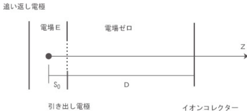
1段加速方式の飛行時間型質量分析の原理説明
