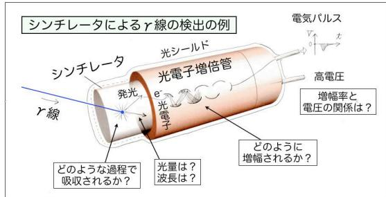
図 1 結晶シンチレータを用いた測定
