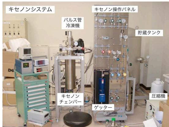
図 2 液体キセノンの実験装置
