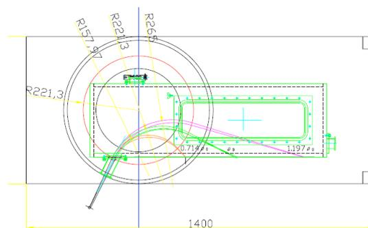
この演習では荷電粒子の軌道と運動量分析法の基礎について学習します。円形磁極を持つ電磁石を用いたスペクトログラフの場合、比較的簡単な幾何光学的取り扱いをすることで、荷電粒子の軌道と運動量の良い相関が得られることがわかっています。原子核のなかには、弱い相互作用で壊変（ベータ崩壊）して、電子（ベータ線）を放出するものがあります。この円形磁極スペクトログラフを用いて、ベータ線のエネルギースペクトル（エネルギー分布）の測定を行います。スペクトログラフの軌道計算、真空槽の設置と排気運転、焦点検出器の設置、電磁石の運転、磁場測定、ベータ線スペクトルのデータ解析などなど、実際の素粒子原子核実験と同様の手順を一通り体験できます。
