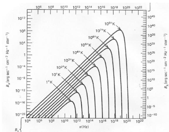
この演習では、既存のアンテナやレシーバー等を利用して、12GHz の周波数で宇宙背景放射を検出し、その強度から温度を測定することを目標とします。アンテナやレシーバーには普通に市販されている C S ・ B S アンテナまたはホーンアンテナを使います。アンテナで受けた宇宙背景放射をレシーバーで検知して、ダウンコンバートしたのち、アンプを通して検波します。最終的に電力として測定されます。測定される電力には、宇宙背景放射以外にも、地球大気からの放射、アンテナ・レシーバー・電子回路自身がつくるノイズからの寄与が存在します。宇宙背景放射以外のこれらの成分は、数十 K という換算温度を持っており、2.7K よりだいぶ大きいです。目標のためには、これらの成分を上手に取り除く必要があります。そのために、温度較正を正確に行い、測定装置の性能の時間変化を、ディックスイッチを用いてキャンセルさせる必要があります。右図は、昨年度の演習の様子の写真です。
