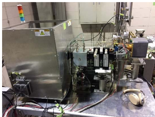
現場に持ち出せる加速器 (テーブルトップ加速器・X線源)
