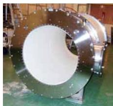
です。軽いニュートリノにマヨラナ性があれば、モリブデン等の原子核でニュートリノ放出を伴わない二重ベータ崩壊が必ず起きます。図 1 は二重ベータ崩壊実験装置でドリフトチャンバー・ベータ線検出器 Drift Chamber Beta-ray Analyzer (DCBA) と呼ばれています。図 2 は図 1 に組み込まれている超伝導ソレノイドコイルで冷凍機とコイル間の熱伝導だけで冷却する最新式のものです。
