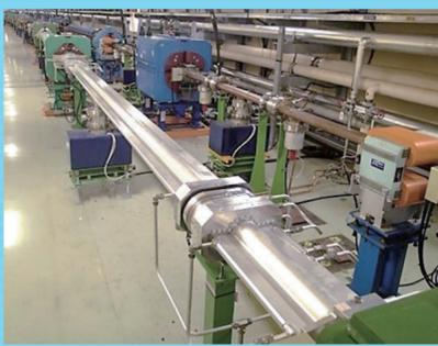
高品質ビームを長時間保つため、ビームの通り道である金属製ビームパイプの内部を超高真空 (~10<sup>-8</sup> Pa) まで排気する
