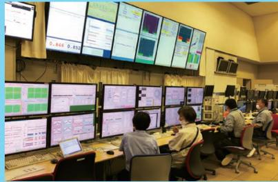
SuperKEKB加速器を集中制御。制御点数、数十万チャンネル!
