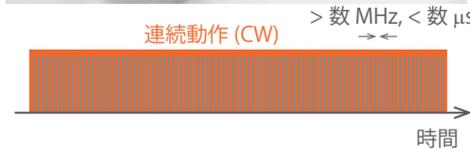
電子ビームは加速空洞に貯められた高周波で加速されます。常伝導加速空洞に比べて、超伝導加速空洞は高周波による空洞の発熱が無視できるほど小さいため、高周波を長時間貯めることができます。供給電力から電子ビーム加速への変換効率が高く、常伝導加速空洞に比べて10万倍以上の高い繰り返しの大強度のビーム電流で運転でき、次世代加速器の有力候補となっています。cERLでは連続運転が可能な超伝導加速空洞を利用して大電流運転を目指しています。KEKB加速器や国際リニアコライダー計画など多くの国内外のプロジェクトとの協力関係の下で、研究開発や運転を行っています。
