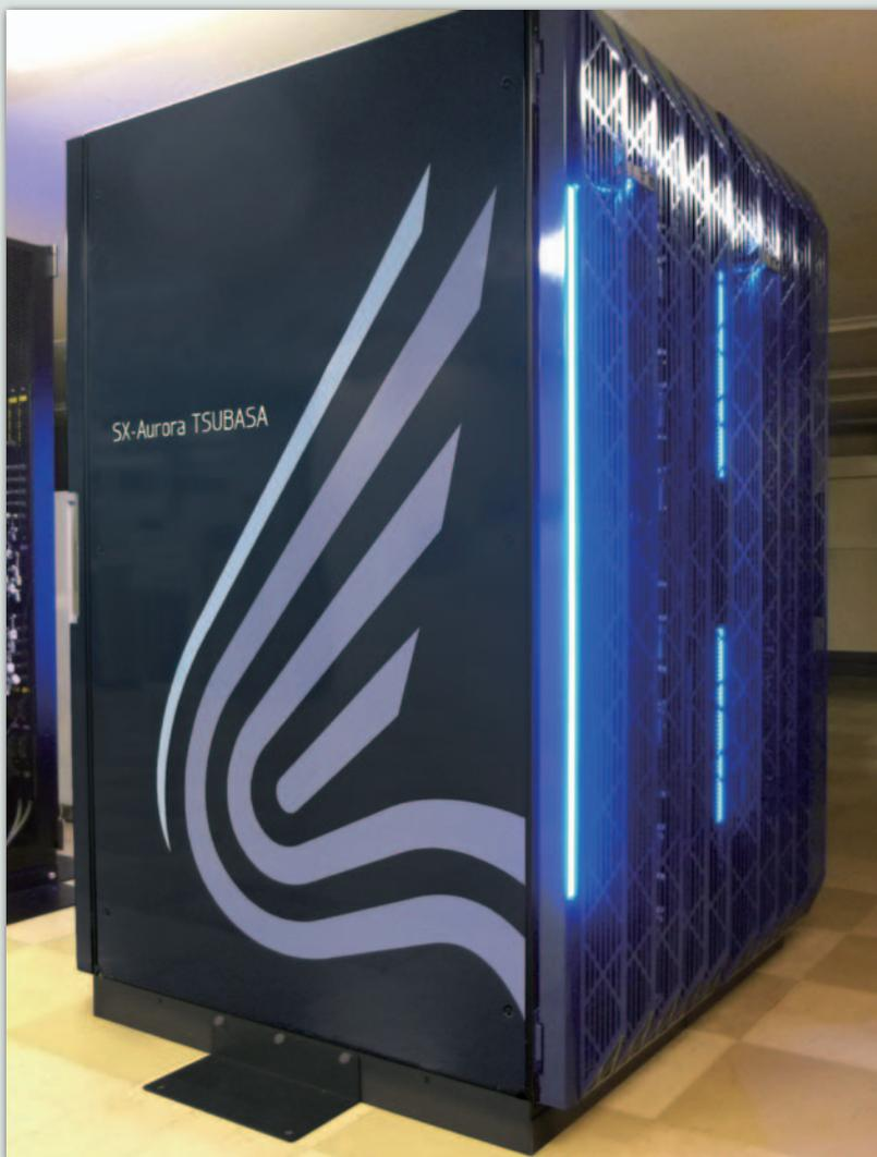
NEC SX-Aurora TSUBASA は、数値演算高速に実行するベクトル・エンジンを備えた、ヘテロジニアスなシステムです。ベクトルエンジンが持つベクトル演算機構と高いメモリアクセス性能は、大規模な数値シミュレーションを高速に実行できます。
