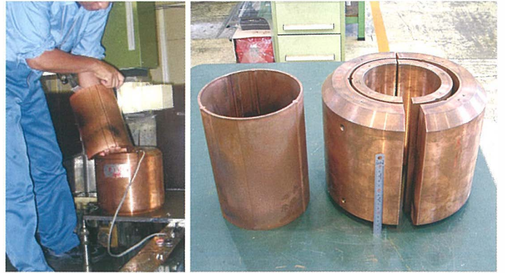
ワイヤカット放電加工機でカット カット後のアブソーバ
