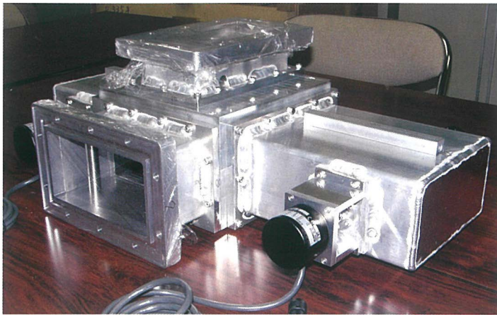
内部に反射板付の導波管（設計・製作）
