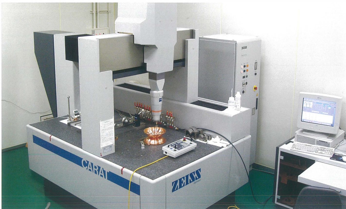
三次元座標測定器を用いた \mu\text{m} オーダーでの精密寸法測定
