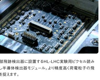
内部飛跡検出器に設置するHL-LHC実験用ピクセル読み出し半導体検出器モジュール。より精度高く荷電粒子の飛跡を捉えます。
