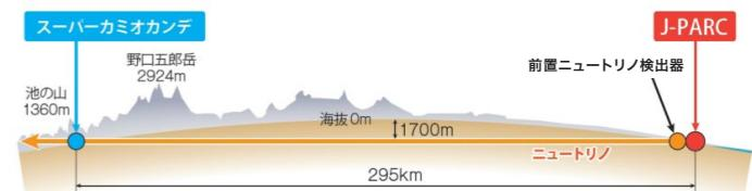
大強度陽子加速器施設J-PARC (Japan Proton Accelerator Research Complex)では、陽子をリニアックで加速後、3GeVシンクロtron(RCS)を経てメインリング(MR)に送り込みます。陽子をキッカと呼ばれる電磁石により内向きに蹴りだし、神岡の方向に向けたあと、ターゲットに衝突させニュートリノビームを生成、スーパーカミオカンデに向けて発射します。
