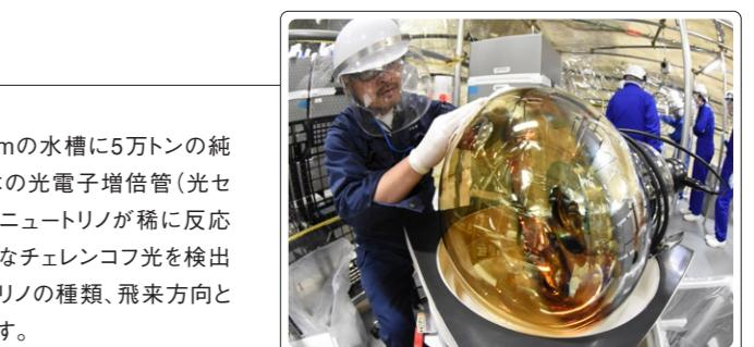
スーパーカミオカンデで使用されている光電子増倍管。世界最大、直径約50cm(写真提供:東京大学宇宙線研究所 神岡宇宙素粒子研究施設)
