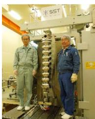
超伝導空洞製造設備
