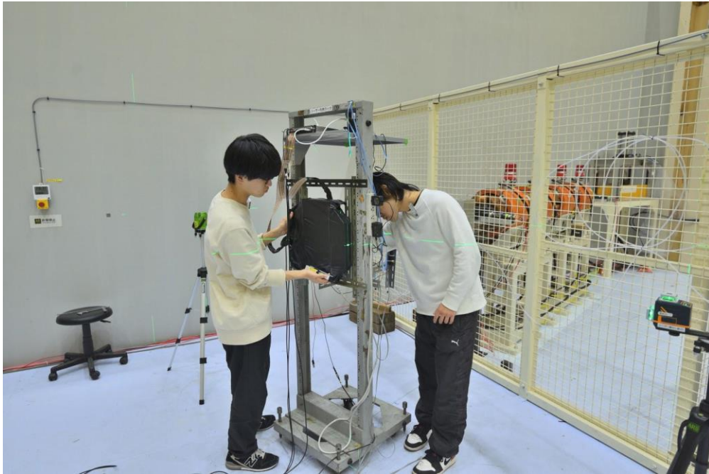
飛跡検出器を組み立てて、正常に動作するかテストする様子
